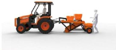
**1** Un operario conduce el tractor máximo a 2 km/h; el otro supervisa el llenado de las canastas y se encarga de reemplazarlas.
