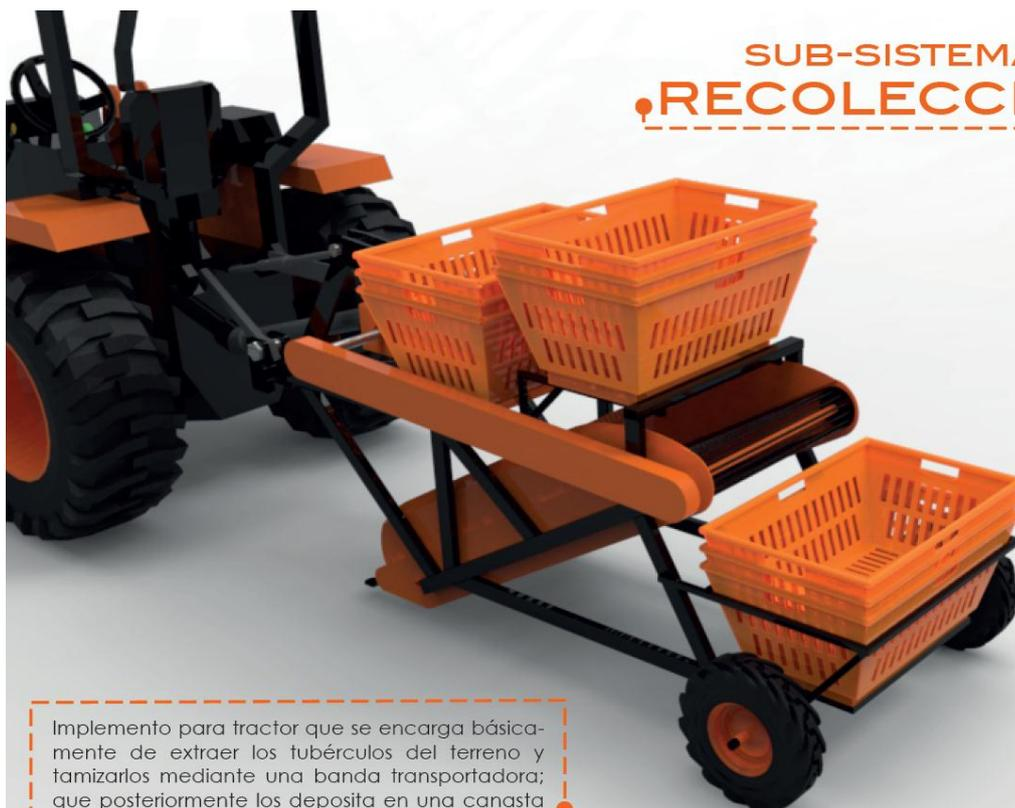
Implemento para tractor que se encarga básicamente de extraer los tubérculos del terreno y tamizarlos mediante una banda transportadora; que posteriormente los deposita en una canasta para ser desplazados al otro vehículo.
