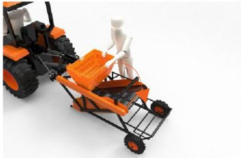
**3** Cuando se agoten las canastas en el área de llenado, se puede abastecer con las apiladas en la parte superior.
