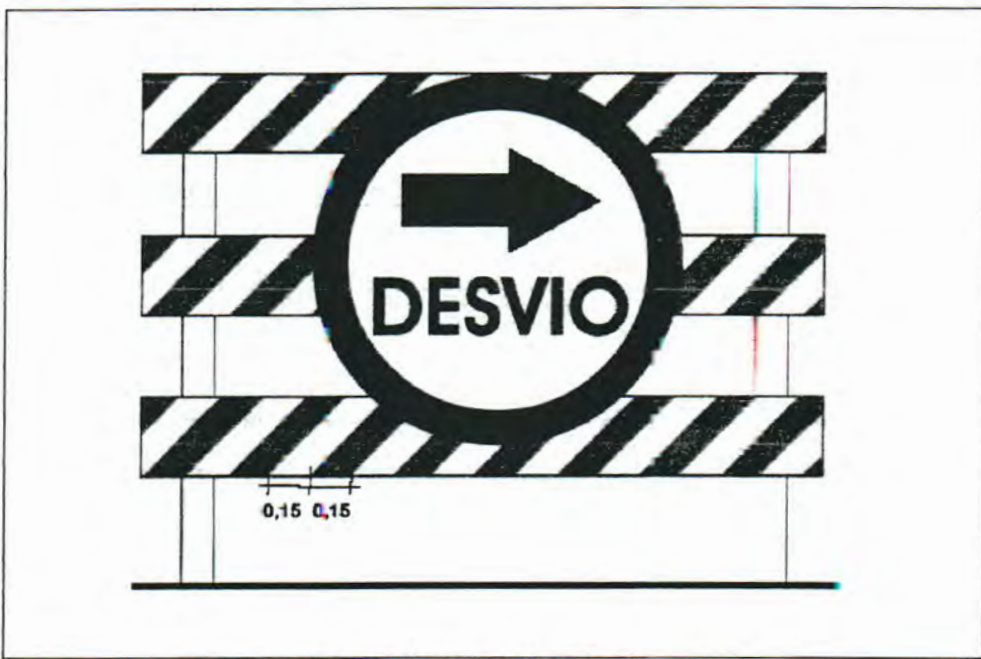
Barricada con señal de desvío
