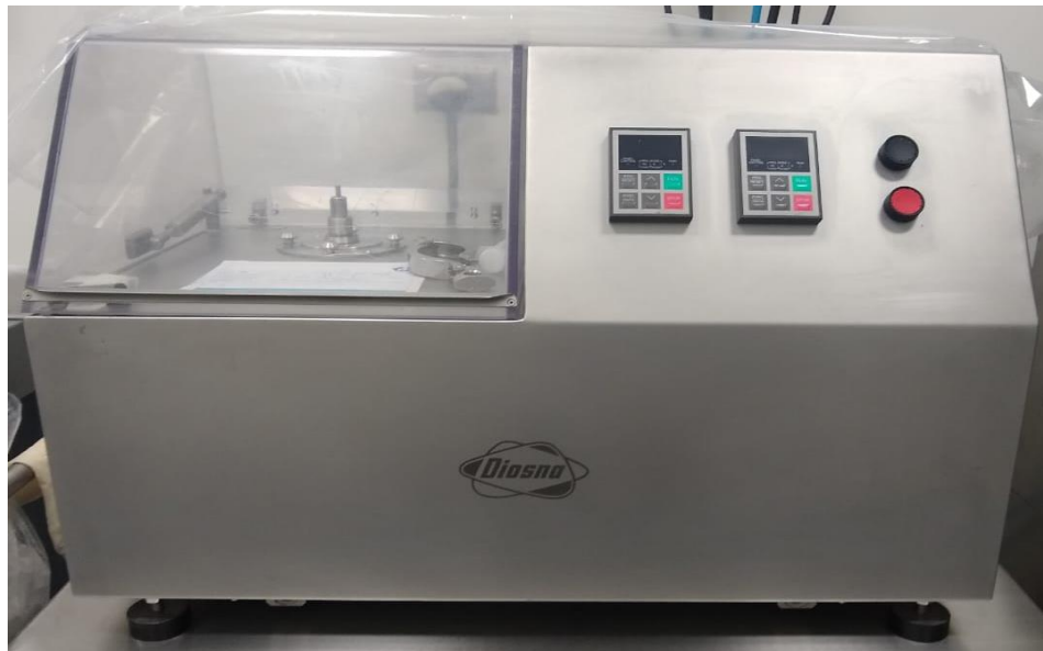
Figura 48. Equipo mezclador – granulador High Shear Diosna
