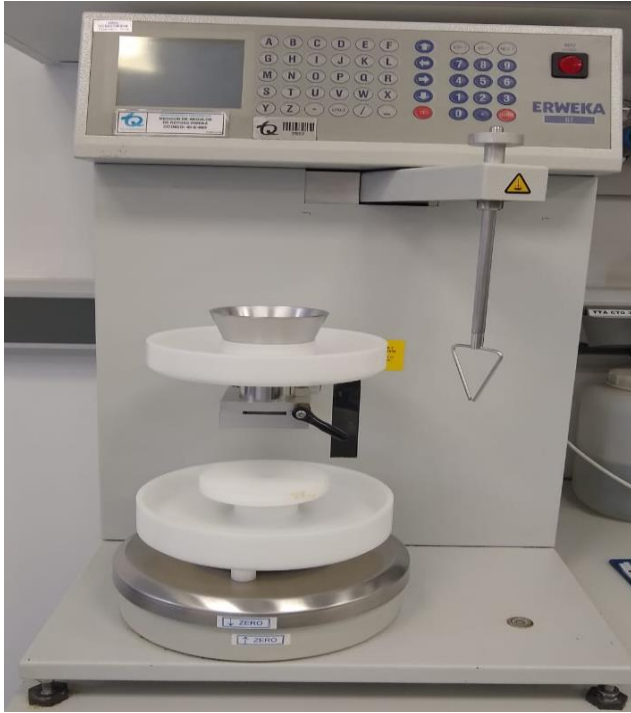
Figura 54. Medidor de ángulos de reposo (GTB)
