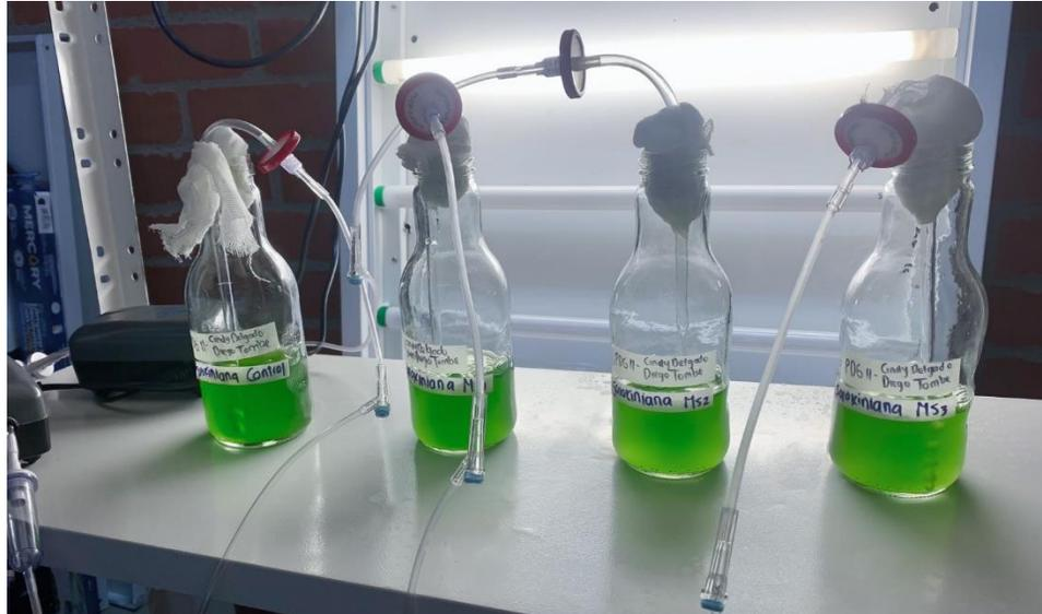
**Figura 1.** Montaje completo de las fermentaciones con los fotorreactores.
